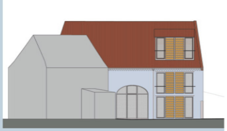
Anbau eines Balkons, »Alte Schule« Lengefeld Neue Fassadenöffnung, Stahlbalkon, Beleuchtung
